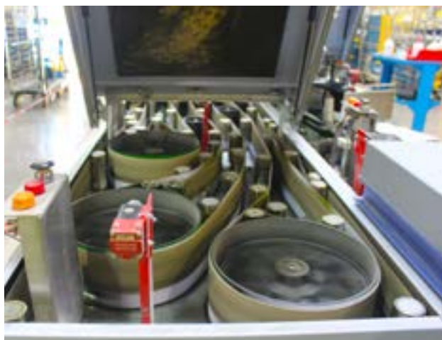
Interior de una de las clasificadoras de cartas del CTA.
